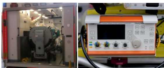
Verlegung mit Rotorrest-Bett im Multifunktions-RTW (linkes Bild) und Beatmungsgerät Oxylog 3000 des Intensivtransportsystems (rechtes Bild)
