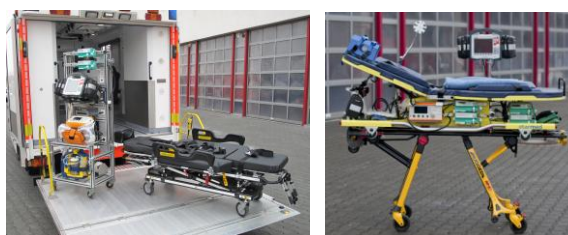
Multifunktions-RTW mit Geräteturm und Schwerlast-Trage (linkes Bild) und Intensivtransportsystem für den Verlege RTW (rechtes Bild)
