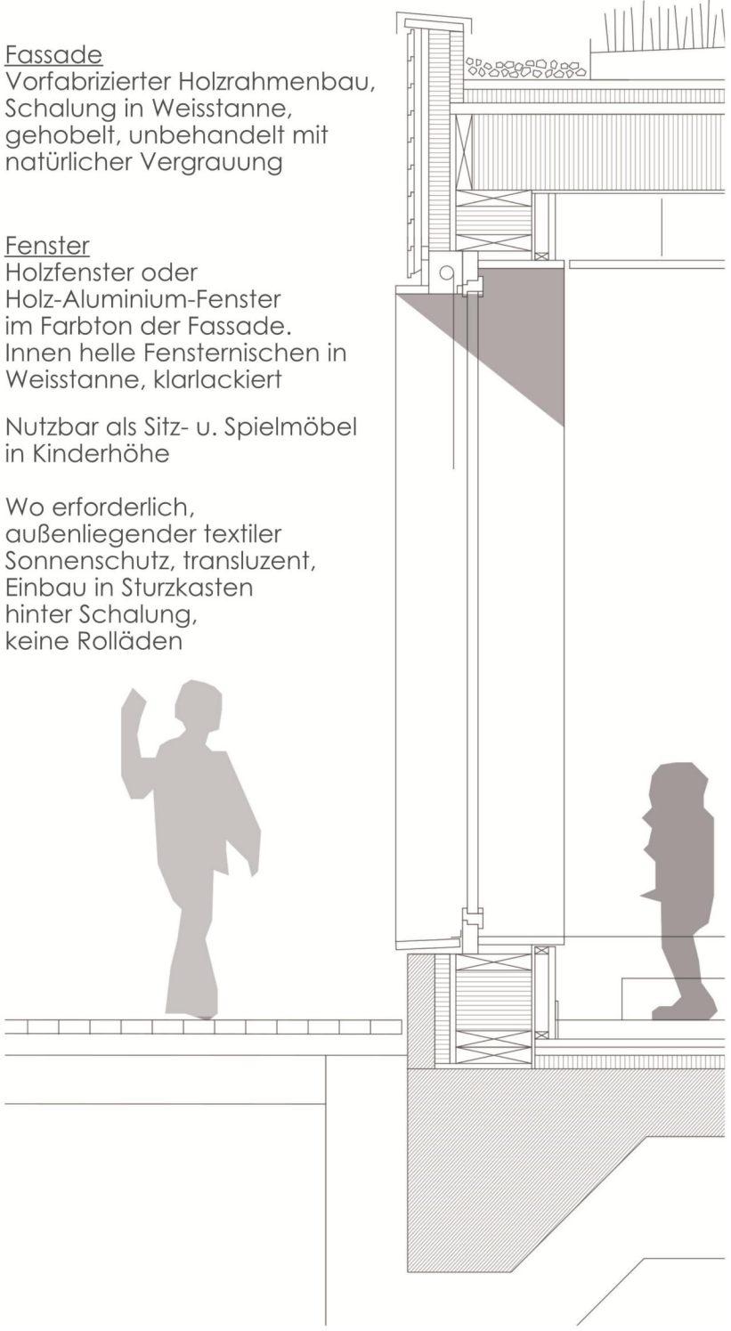
FASSADENSCHNITT M 1:20
