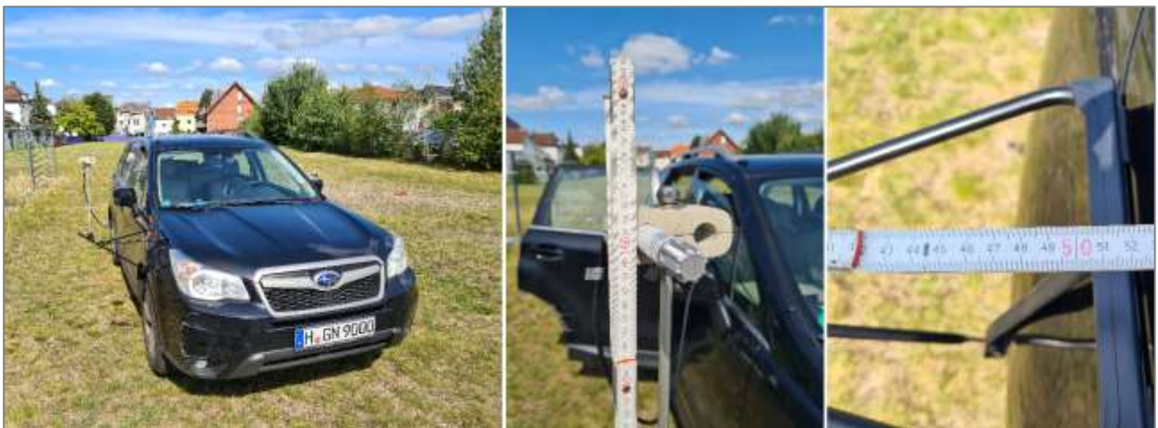
Abbildung 20: Anbringung des Temperatursensors für die Messfahrt am PKW (links), Höhe über Grund (Mitte) und seitlicher Abstand vom Fahrzeug (rechts).
