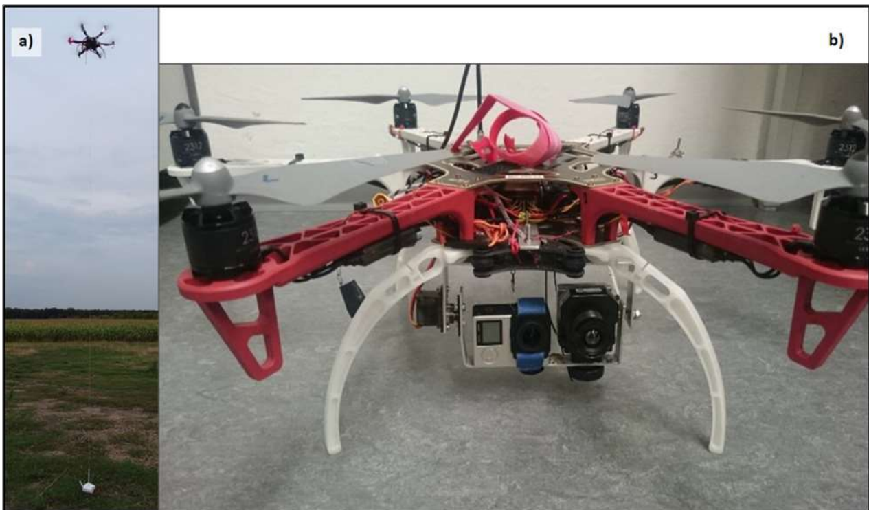
Abbildung 23: (a) Messsystem aus Hexakopter DJI Flamewheel 550 mit angehängter Radiosonde DFM-06 von GRAW. (b) Hexakopter Flamewheel 550 Nahansicht mit Aufhängung für Fotokamera der Marke GoPro und Infrarotkamera von FLIR.
