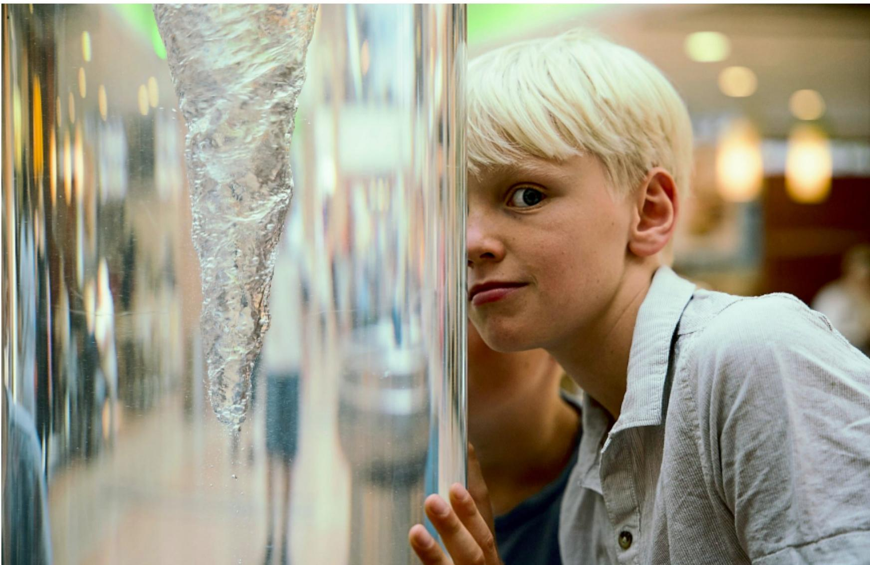
Im Wirbelzylinder entsteht eine trichterförmige Vertiefung, die bei hoher Rotationsgeschwindigkeit als dünner Schlauch weit nach unten reichen kann.
