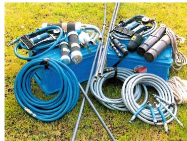
Für die drucklose Prüfung mit Wasser werden die Abwasserkanäle am Anschlusspunkt des öffentlichen Kanals mit einer Absperrblase verschlossen und anschließend bis zur Höhe des tiefsten Entwässerungspunktes (z.B. Bodenablauf im Keller) mit Wasser gefüllt.
