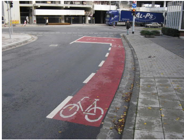
Abb. 32 ARAS mit zuführendem Schutzstreifen und flächenhafter roter Markierung der Fahrbahn (Hannover)
