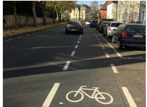
Abb. 13 Beispiele für Radverkehrsführung nach dem Trennungsprinzip (links: Gemeinsamer Geh- und Radweg) und Teilseparation (rechts: Radschutzstreifen)
