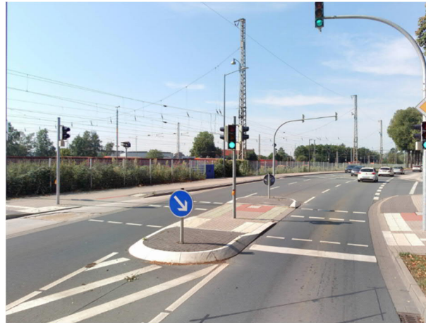
Abb. 39 Querungshilfe mit Mittelinsel und Lichtsignalanlage (Paderborn) 42
