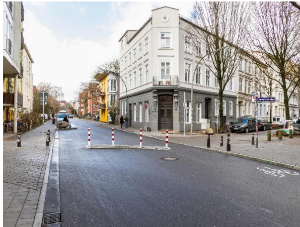
Abb. 34 Modaler Filter als Diagonalsperre, hergestellt mit Bord und zusätzlich gekennzeichnet mit Pollern (Hamburg)
